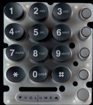
SilikonSchaltmatte mit lackierter Oberfläche. Ausgelaserte und hinterleuchtete Symbole.
